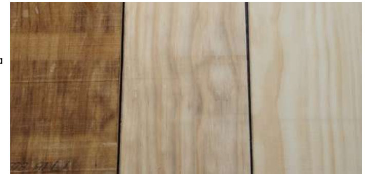
VERKLEURING: RUW OPPERVLAK, NA AFSCHAVEN VAN 3MM EN NA AFSCHAVEN VAN 6 MM VAN HET RUWE OPPERVLAK
